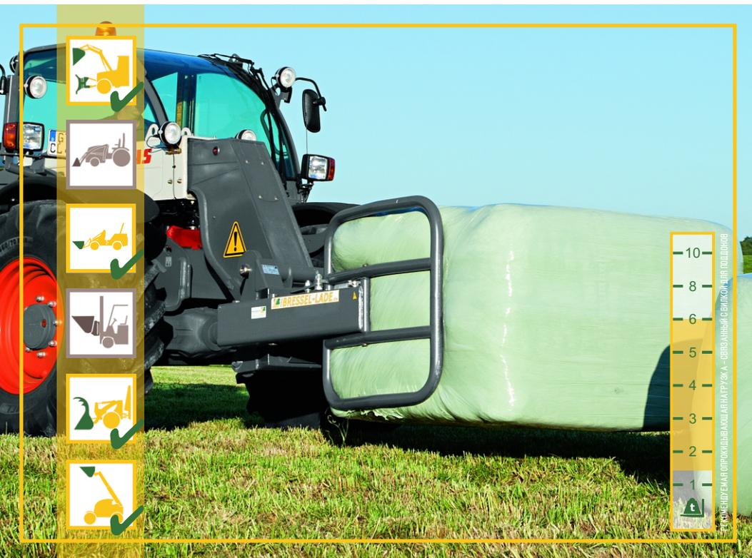
Обеспечивает лёгкую и безопасную транспортировку круглых и прямоугольных тюков
