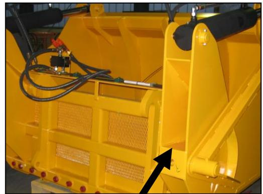
An dieser Position ist die Seriennummer zusätzlich im Gerät eingeschlagen.
