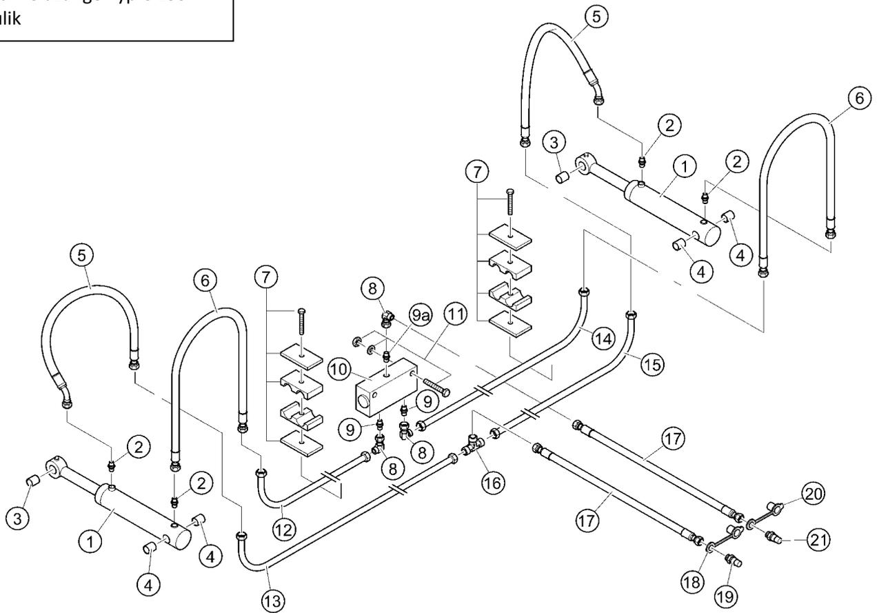
**Silageschneidzange Typ C 199 - Hydraulik**
