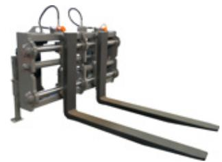
Das Zinkenverstellgerät dient zum Aufnehmen von palettierten Gütern. Die hochwertigen Gabelzinken sind im Abstand hydraulisch verstellbar. Die Verstellung erfolgt synchron. Es werden Gabelzinken mit höher angesetzten Aufnahmepunkten (Form B) verwendet. Das Gerät ist nicht zum Klammern oder Greifen geeignet.
