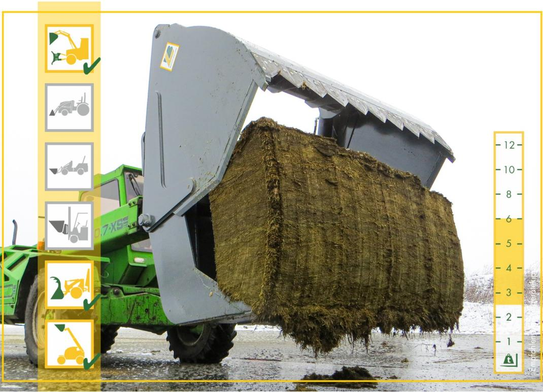
Die Silageschneidschaufel ist ein Anbaugerät zum sauberen Entnehmen von Silage jeglicher Art aus dem Silostock. Mit der verwindungssteifen Oberzange aus hochvergütetem Feinkornstahl kann selbst extrem verdichtete Silage sauber geschnitten werden.
