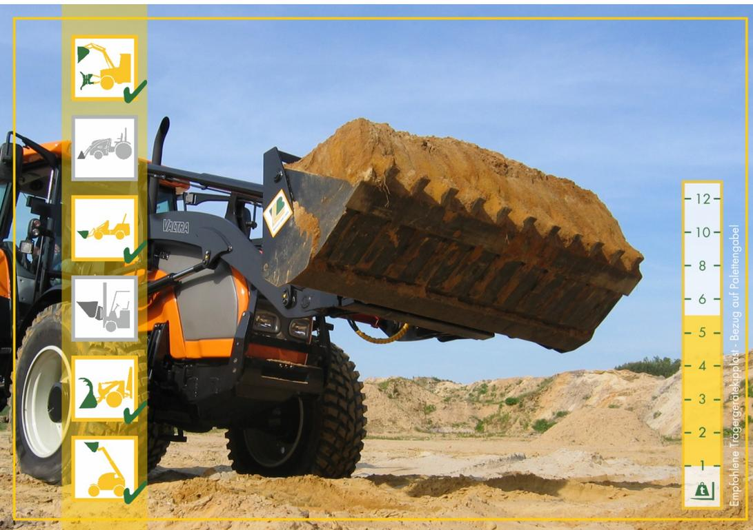
Die Klappschaufel bietet vielfältige Einsatzmöglichkeiten: - Laden, wie mit einer Schaufel, - Entleeren / Dosieren ohne Auskippen der Schaufel, - Planieren mit geöffneter Schaufel, - Sammeln von Restmaterial, - Greifen von z.B. Bordsteinen
