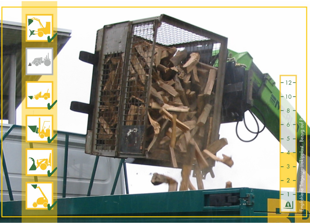
Das Kistendrehgerät ermöglicht durch 205° Drehbereich die restlose Entleerung von Kisten mit Kartoffeln, Obst, Wein, Kompost oder Holzscheite.
