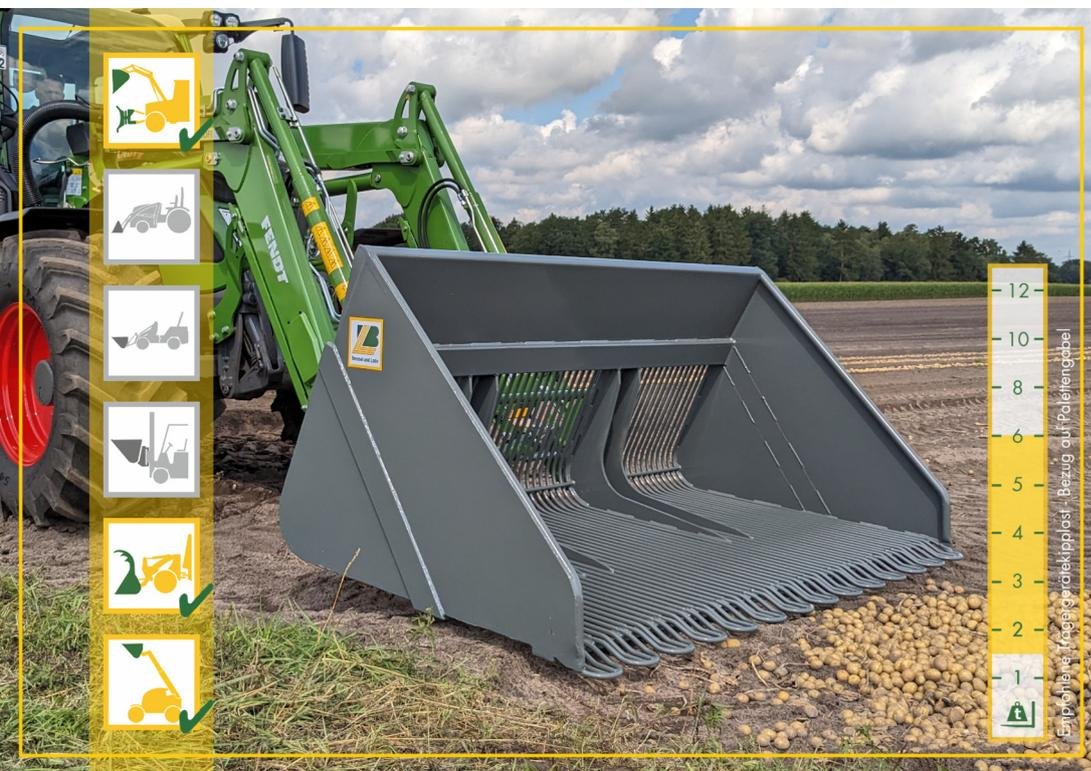
Die Körbe ermöglichen das Aufnehmen von Kartoffeln. Durch den angehobenen Korbboden können Steine und Verschmutzungen hindurch fallen.
