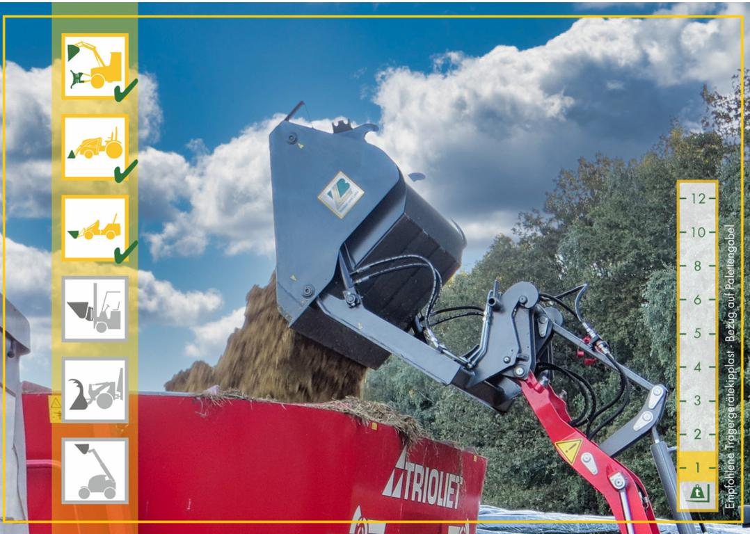
Die Hochkippschaufel ermöglicht die Steigerung der Ausschütthöhe und des Auskippwinkels.
