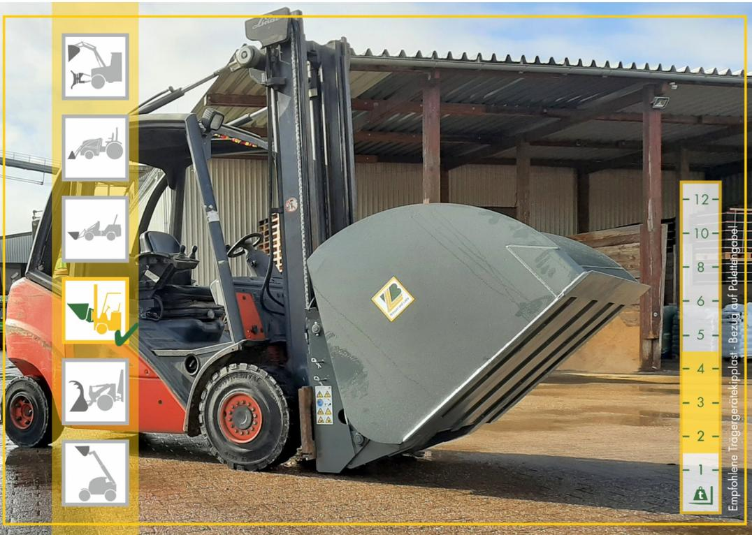
Dieses Anbaugerät wird direkt auf den Gabelträger montiert. Es zeichnet sich durch hohe Volumen und großen Kippwegen aus. (Foto zeigt Sonderausführung)
