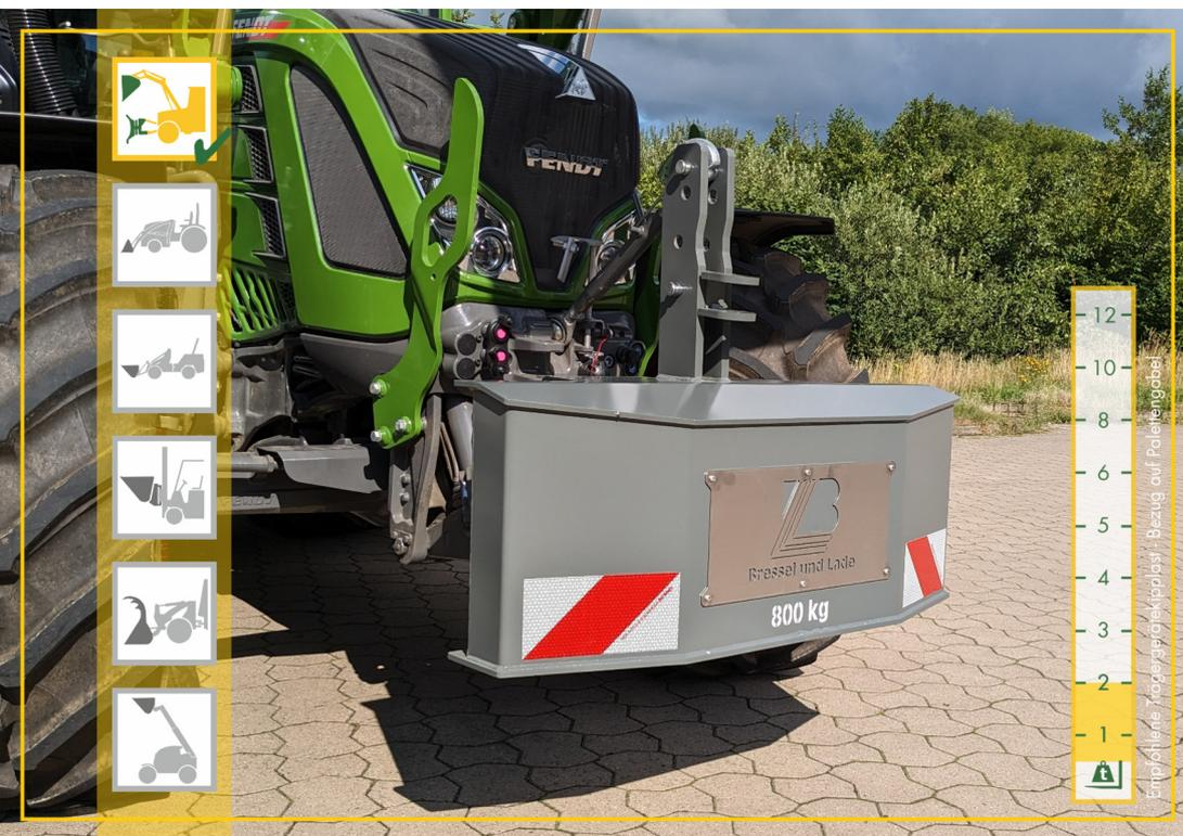
Das robuste Standardgewicht in kompakter Bauweise mit einem Gewicht von 500kg bis 1000kg.
