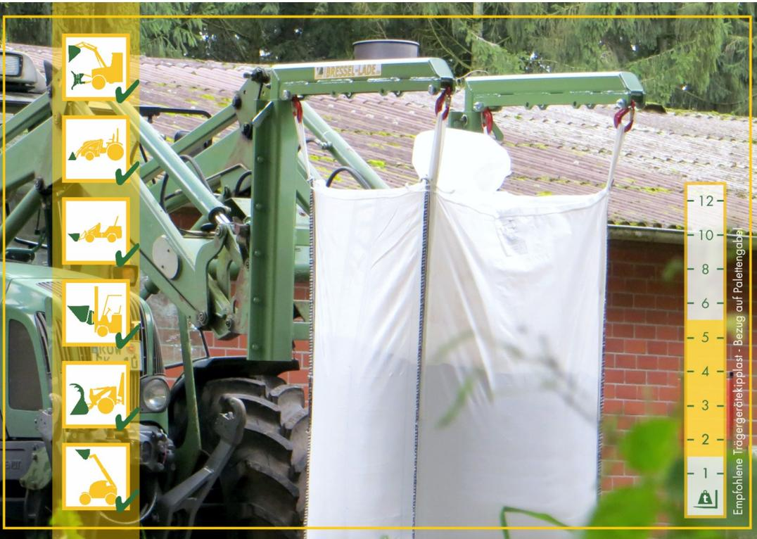
Der Big-Bag-Träger ermöglicht den sicheren Transport von Big-Bags. Durch die Erhöhung H40 können die Big-Bags z.B. problemlos zum Befüllen von Sämaschinen oder zum Beladen von LKWs verwendet werden.
