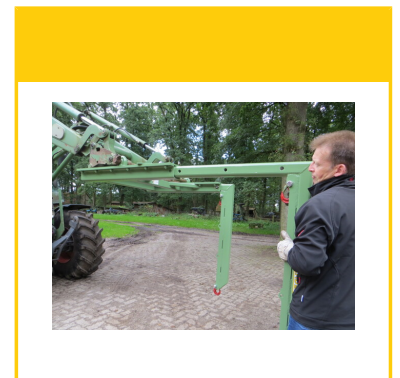
2 Stück dieser Big-Bag-Träger erlauben den Transport von Big-Bags mit einem Standard-Gabelträger.
