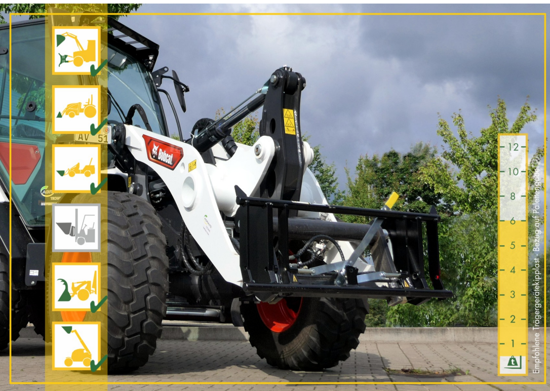
Adapterrahmen für Kleintraktoren, Hoflader, Radlader, Teleskoplader oder Bagger mit Schnellwechsler zur Aufnahme von Anbaugeräten mit Euro-Schnellwechselsystem
